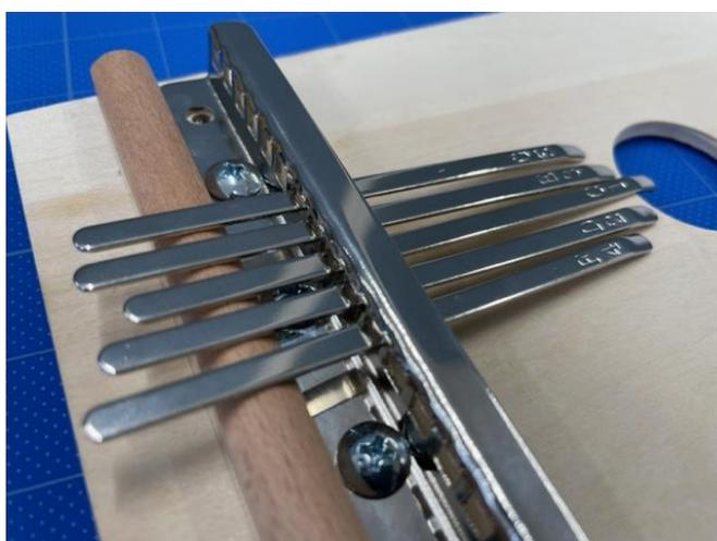
**4** キーの下に、金属の棒をのせる枕木を差し込む。すべてのキーをのせたら、金属の棒を枕木にのせる。
